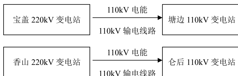
图 5-2 输电线路运行工艺流程示意图
